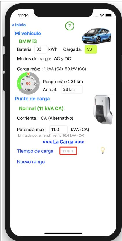
Para el vehículo elegido, aparece su nombre completo, su foto, la capacidad de la batería, los modos de carga que tiene (CA o CC) con la potencia máxima, el consumo en Wh / km; el velocímetro le permite elegir la velocidad de conducción girando el punto rojo; el consumo se adapta en consecuencia (Nota: de acuerdo con una **estimación** promedio de la variación del consumo).
