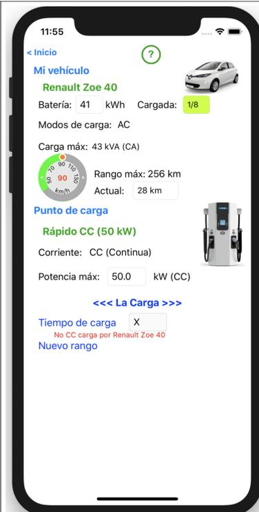
EVZenith realiza verificaciones de compatibilidad: si el vehículo solo se carga en CA y usted ha elegido un punto de CC, la carga no es posible; o si ha elegido un terminal de modo 3 (conector Tipo 2) para Twizy, mientras que su cable fijo solo puede conectarse a una toma de corriente doméstica.
