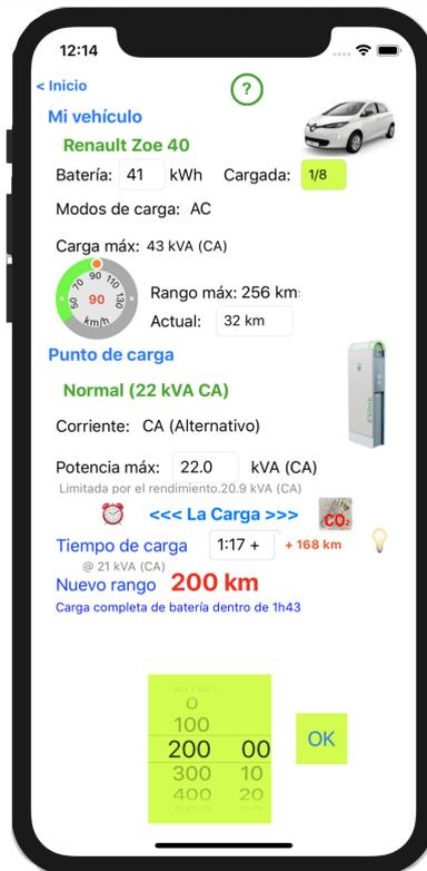
Establezca el estado de carga tocando 'Cargado' y elija el valor girando el Rolodex (graduado en 1/8 de capacidad)
