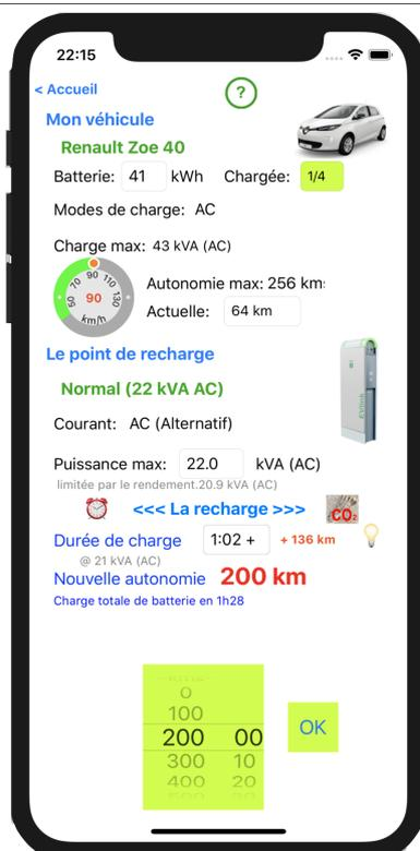
Réglez l'état de charge en tapant sur 'Chargée' et choisissez la valeur en tournant le Rolodex (gradué en 1/8 de capacité)
