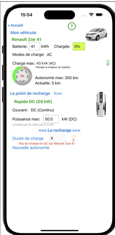
EVZenith effectue les vérifications de compatibilité : si le véhicule ne charge qu'en AC et que vous avez choisi un point DC, la charge est impossible ; ou si vous avez choisi une borne mode 3 (prise Type 2) pour Twizy alors que son câble fixe ne peut se brancher que sur une prise domestique.
