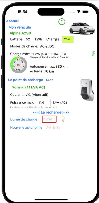
Pour le véhicule choisi, apparaissent son nom complet, sa photo, la capacité de la batterie (modifiable), le niveau de charge actuel (réglable), les modes de charge dont il dispose (AC ou DC) avec la puissance maximale, la consommation en Wh / km ; le compteur de vitesse permet de choisir la vitesse de conduite en tournant le point rouge ; la consommation est adaptée en conséquence (Nota : selon une **estimation** moyenne de la variation de consommation).
